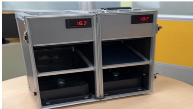
可攜式之電致變色與玻璃貼膜的對照功能實驗箱
